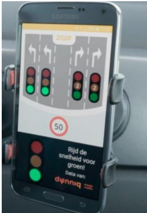
Figuur 14 iVRI stuurt informatie naar de weggebruiker.
